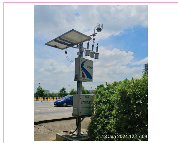
รูปที่ 3.2-13 ระบบเฝ้าระวังคุณภาพสิ่งแวดล้อม แบบ Online Real time (บริเวณด่านเก็บค่าผ่านทางพิเศษจุฑาโชติ)
